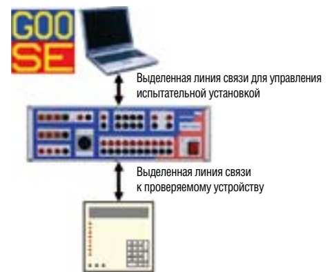
Рис. 3. Идеальная схема установки с выделенными линиями связи
