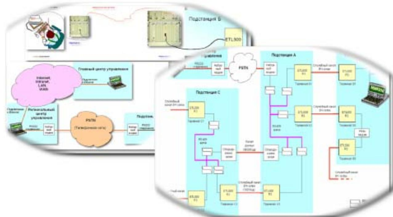
При этом оператор, находящийся в некотором центре управления и сбора информации, на экране компьютера в реальном масштабе времени может отслеживать состояние всей сети, и непосредственно из центра принимать решение о выводе тех или иных каналов из работы!
