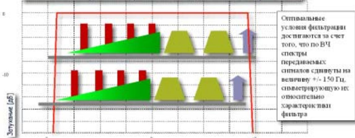
Этому способствует и тот факт, что спектр сигналов ТЛФ начинается с частоты 300 Гц. Поэтому, для получения симметричных характеристик ВЧ фильтрации и уменьшения ВЧ защитных интервалов возможно «сдвинуть» спектр сигнала в линии на 150 Гц, а потом «вернуть» обратно.
