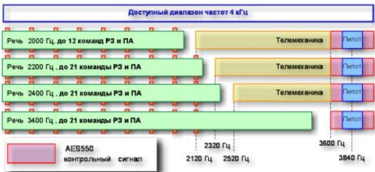
Функционально ВЧ каналы делятся на «связные» и «релейные», следовательно, и объединять надо именно эти сигналы.
