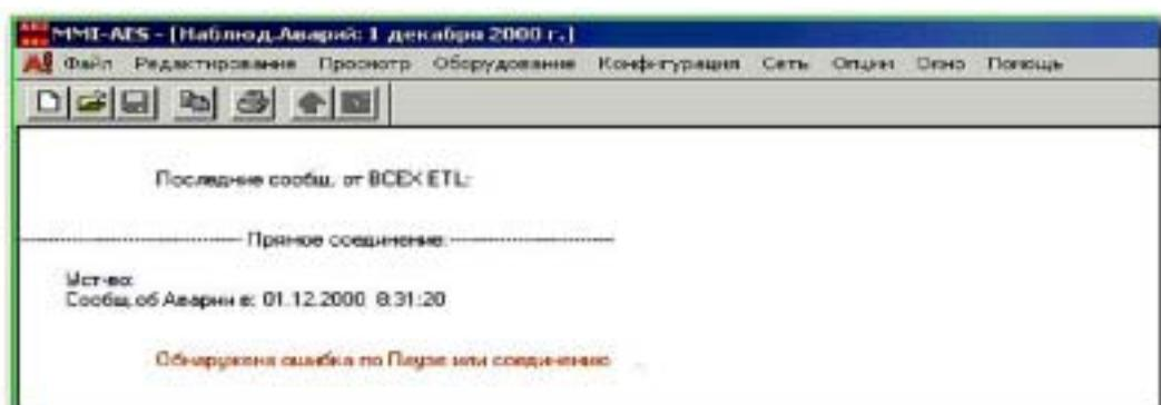
Список наблюдаемых терминалов составляется один раз. После этого функция мониторинга может быть включена или выключена нажатием одной клавиши. Когда функция активирована, все устройства, занесенные в список, начинают периодически с заданным интервалом (ежедневно, ежечасно, каждые XX минут) опрашиваться.
