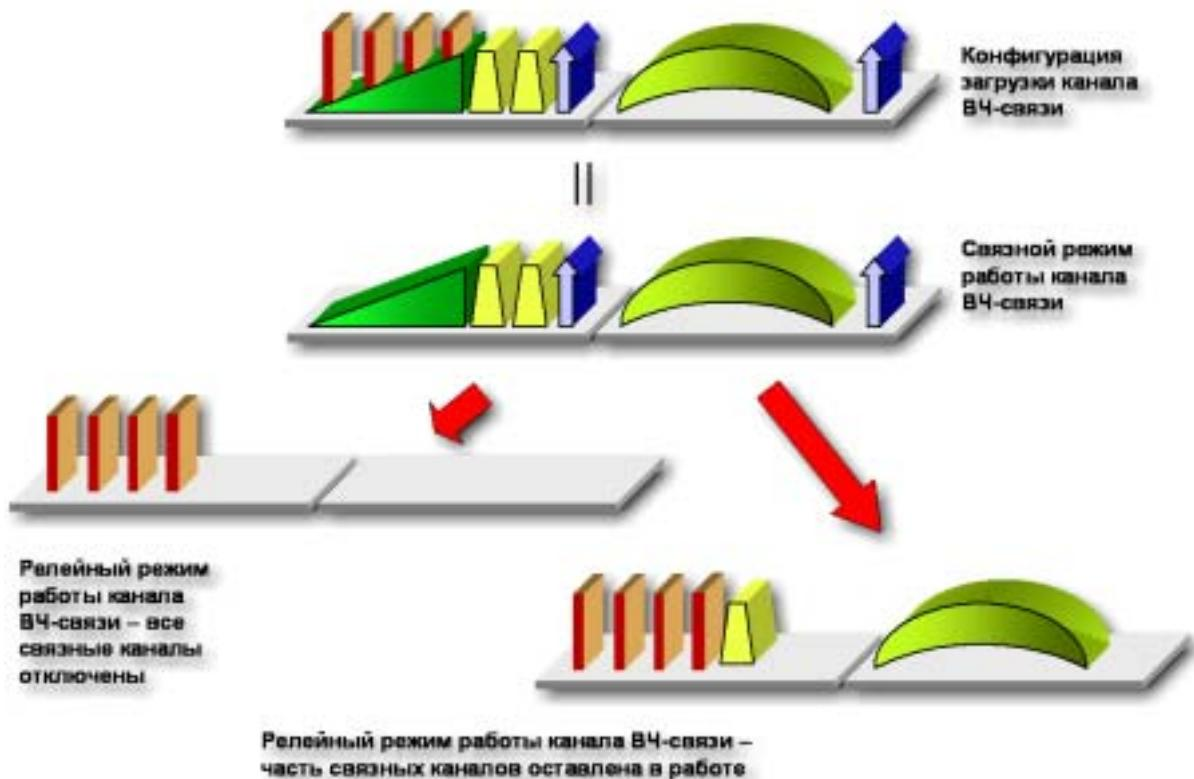
При этом может происходить как полная подмена функций, так и частичная, то есть, во время передачи сигналов команд отдельные «связные» каналы могут оставаться в работе. Это может быть важным, например, для каналов ТМ оперативного управления процессами энергогенерации, передачи и энергопотребления.
