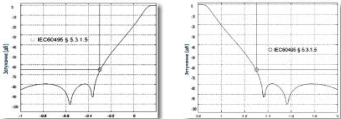
Решающим фактором здесь становится механизм цифровой фильтрации сигналов. Селективность спектров становится столь велика (более 65 дБ), что позволяет
