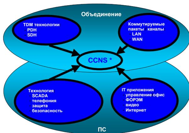
В последние 3-7 лет (в том числе и в России) достаточно активно применяется совмещение функций передачи сигналов речи, ТМ и защиты. В ВЧ технике для этого используется принцип частотного уплотнения с разделением по времени, в кабельных каналах – TDM мультиплексирования.
